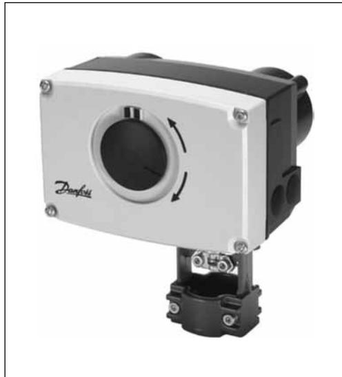
Электроприводы AMV 25SD и AMV 25SU предназначены для управления регулирующими клапанами VF3 и VFS2 с условным проходом до 50 мм. При обесточивании, в зависимости от типа привода, возвратная пружина выдвигает или втягивает его шток.
